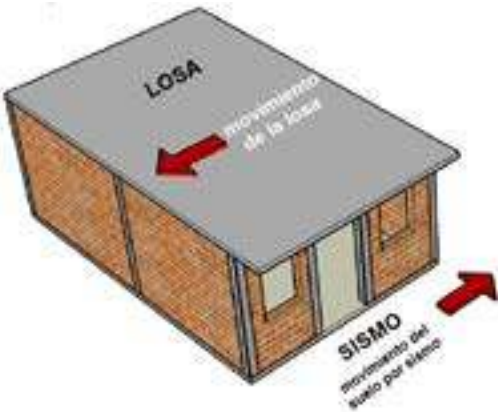
20 Figura 20. Desplazamiento por sismo de la estructura en el sentido corto
