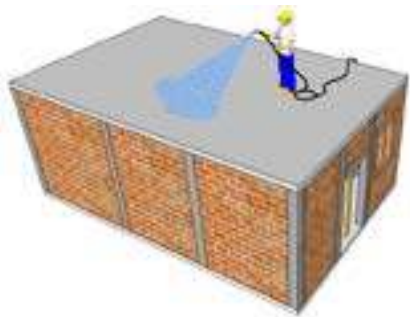
Figura 99. Curado del concreto con agua
