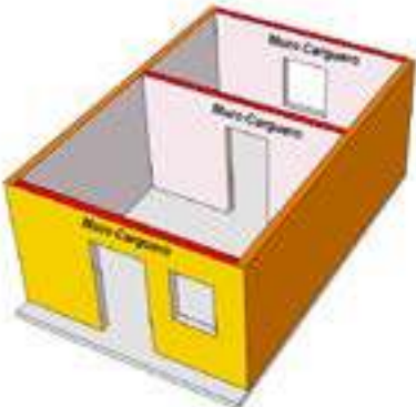
Figura 84. Muros donde se apoyará la losa (Muros Cargueros o de Carga)
