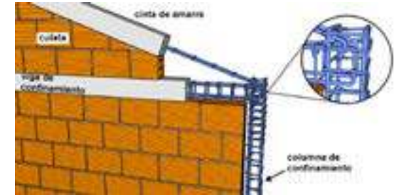
Figura 78. Anclaje de cintas de amarre a columnas
