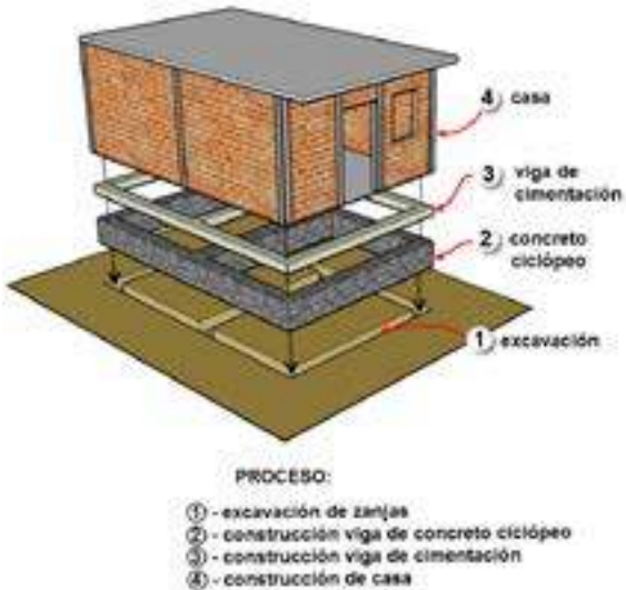
Figura 43. Proceso para construcción de la casa
