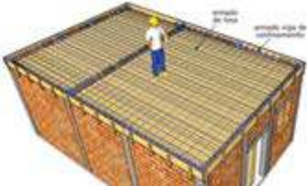
Figura 95. Largueros, puntales y formaleta de la losa y las vigas
