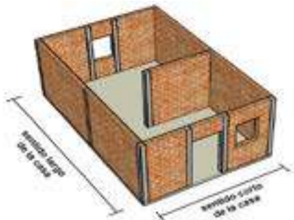
Figura 22. Cantidad suficiente de muros en el sentido largo y corto de la casa
