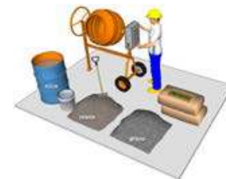
Figura. 36. Mezcladora y materiales para hacer el concreto.
