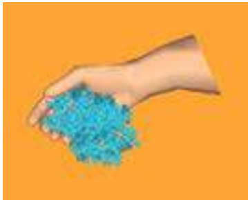
Figura 38. Se desmorona, falta agua o falta arena. Fuente: adaptada de [2].
