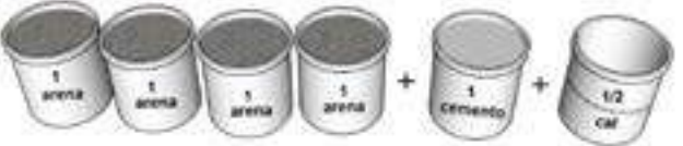
Figura 40. Mortero de pega con cemento-arena, dosificación 1:4 en volumen
