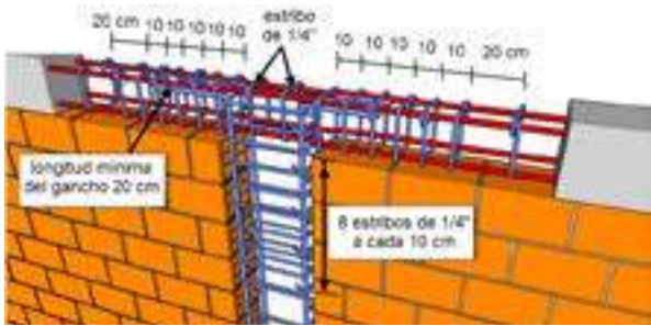
Figura 72a. Armados y dimensiones de vigas de confinamiento
