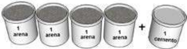
Figura 40. Mortero de pega con cemento-arena, dosificación 1:4 en volumen
